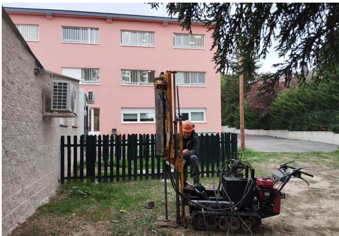
FOTOGRAFIA 8: Vista de la realización del Penetrómetro 4.
