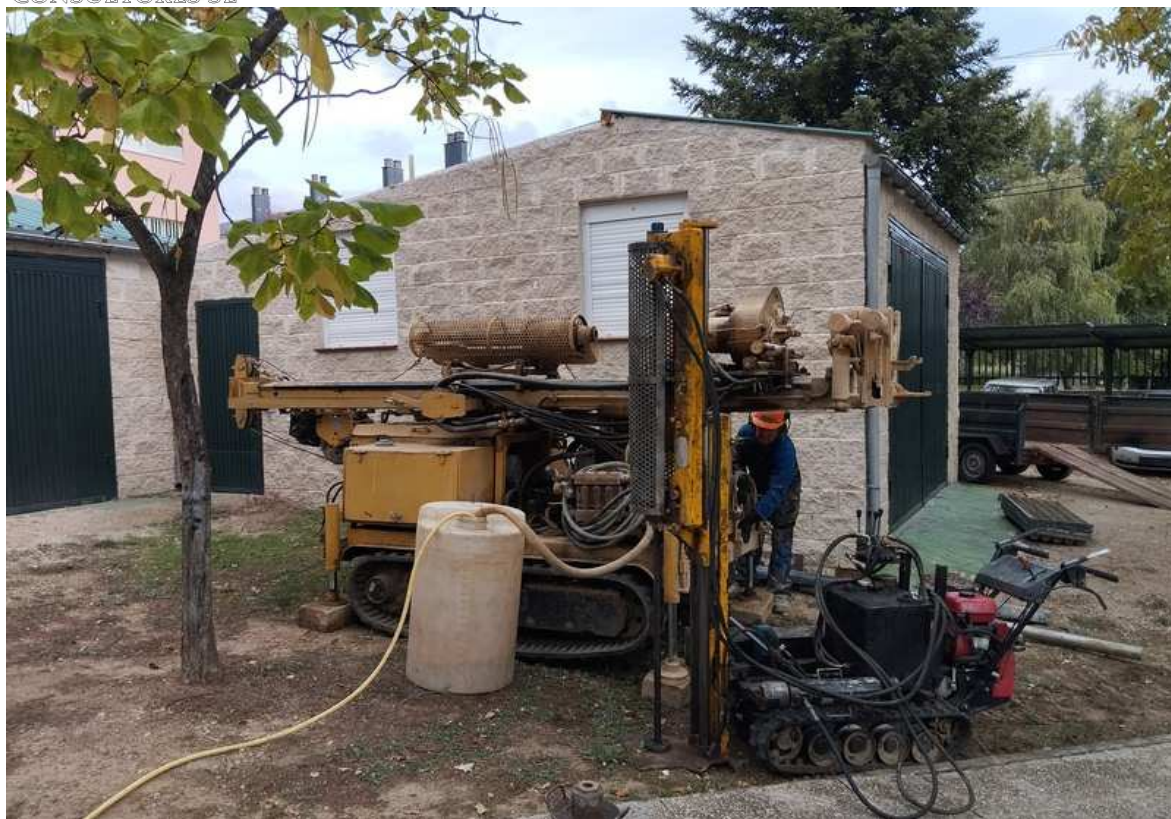
FOTOGRAFIA 5: Vista de la realización del Penetrómetro 1
